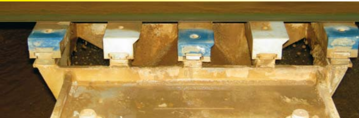
CeramX im kombinierten Einsatz mit Al-Oxid Keramik
